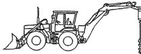
Esempio di terna con trivella
